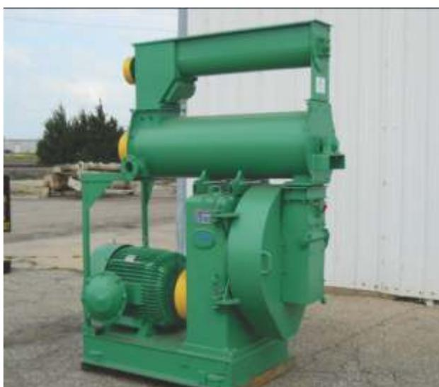
Fig 12. Peletizador de alimentos equipado con un acondicionador en la parte superior (California Pellet Mill – USA)
